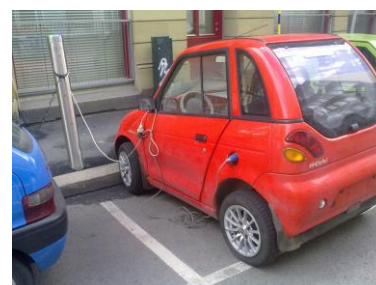
Fig 11 – Skjøteledning på ladekabel
